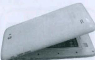
3. 插入电池，将金属接点端朝内，然后轻轻将电池推入到底。
