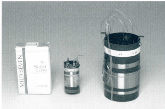
写真3 キットに使用されている超大型並四再生検波コイル(右)。中央は、従来用いられてきた並四コイル
