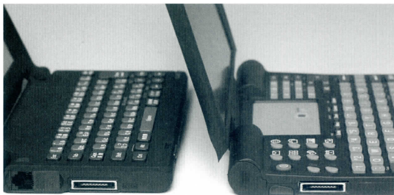
写真6 形状的には同一のMC-CS12(左)とGeofox-Oneのシリアルコネクタ
