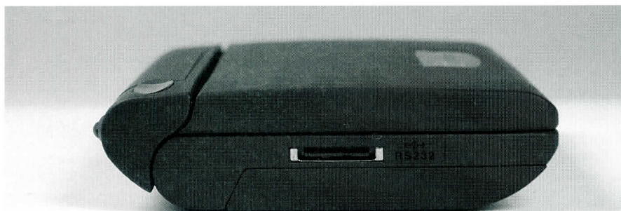
写真3 Psion Series 3cのRS232Cポートコネクタ
