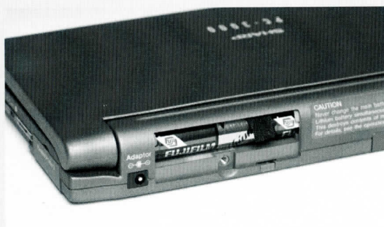
写真8 メインバッテリーの格納状況
