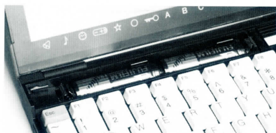
写真4 メインバッテリーの格納状況
